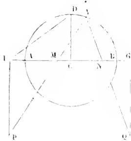
C étant le centre du cercle et CD le rayon perpendiculaire à AB, si par les deux points F, G, également distants du centre C, on élève sur AB les perpendiculaires FP, GQ, égales l'une et l'autre à DF, et que des deux points P, Q on mène à un point quelconque V de la circonférence les droites PV, QV qui rencontrent le diamètre AB en M, N, la somme des carrés des côtés VM, VN
